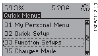
Рисунок 8.3: Шаг 3: С помощью навигационных кнопок "вверх"/"вниз" выберите настройку функций. Нажмите [OK].
