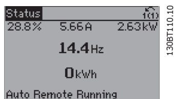
Рисунок 8.1: Шаг 1: Включите преобразователь частоты (зажигается светодиод On)
