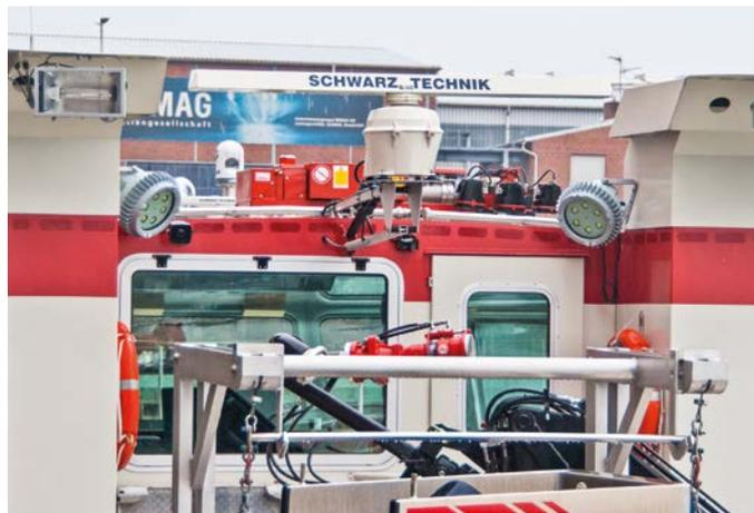
экономичность. С потребляемой мощностью от 60 до 50 Вт светильники серии LPL LED идеально подходят для замены светильников от 70 до 250 Вт с газоразрядными лампами высокого давления. Такая замена дает возможность за счет малого энергопотребления и длительного срока службы светодиодного модуля ( $> 50\,000$  ч.) сохранять эксплуатационные расходы на низком уровне.
