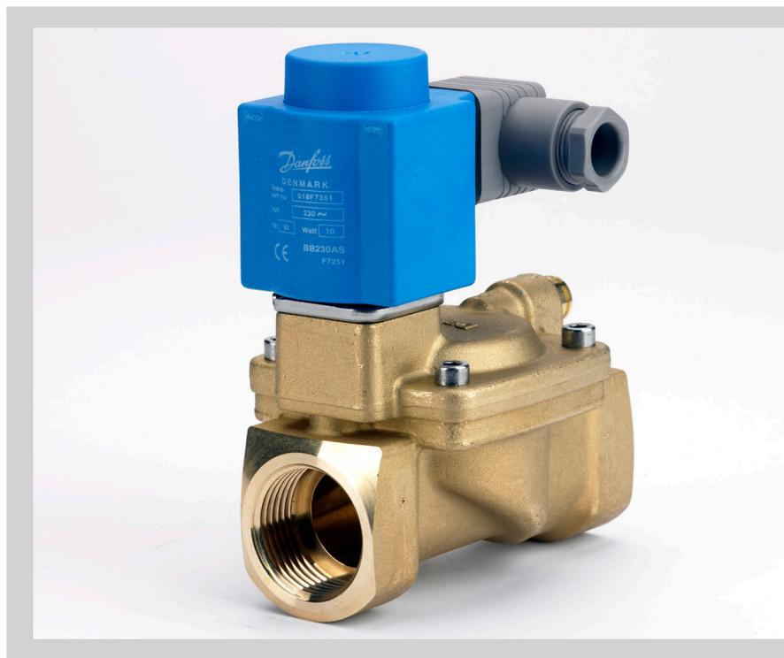
EV224B – двухпозиционный двухходовой электромагнитный клапан с сервоприводом предназначен для использования в системах с давлением до 40 бар и температуре рабочей среды до 60 °С. Выпускаются в нормально закрытой и нормально открытой модификациях. Встроенный стандартный фильтр управляющей системы, заменяемое выравнивающее отверстие, а также класс защиты до IP67 (в зависимости от катушки) обеспечивают надежную работу.
