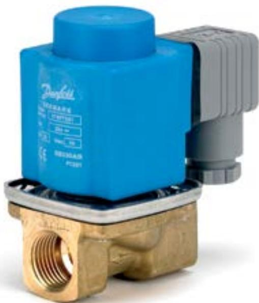
Клапаны типа EV220В (Ду 6-22) представляют собой линейку двухпозиционных двухходовых электромагнитных клапанов прямого действия с сервоприводом и резьбовым присоединением от 1/4 до 1 дюйма.
