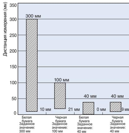
Зависимость дистанции измерения от материала контролируемого объекта
