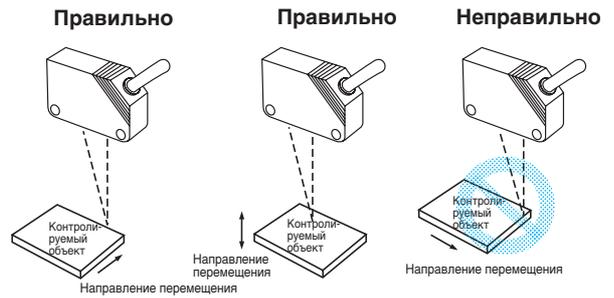
Если контролируемые объекты значительно отличаются цветом и материалом, установите датчик как показано на следующем рисунке.
