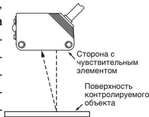
Однако, если контролируемый объект имеет глянцевую поверхность, следует наклонить датчик на 5° - 10°, как показано на рисунке, убедившись в том, что датчик не подвергается воздействию объектов, расположенных на заднем плане.
