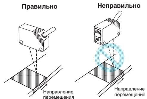
**Регулировка моделей с установкой дистанции измерения**
